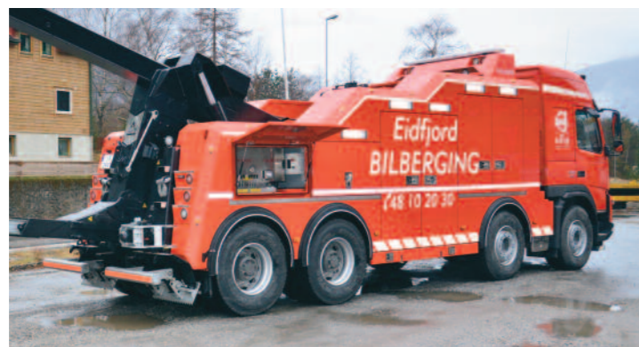
Falkon FAW25000 er det største bergingspåbygget fra nederlandske Falcon. Det meste av tilgjengelig utstyr er på plass.
